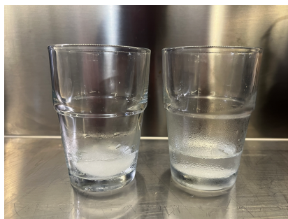
Obr. 2: Stále tající neposolený led (vlevo) a roztátý posolený led (vpravo)
